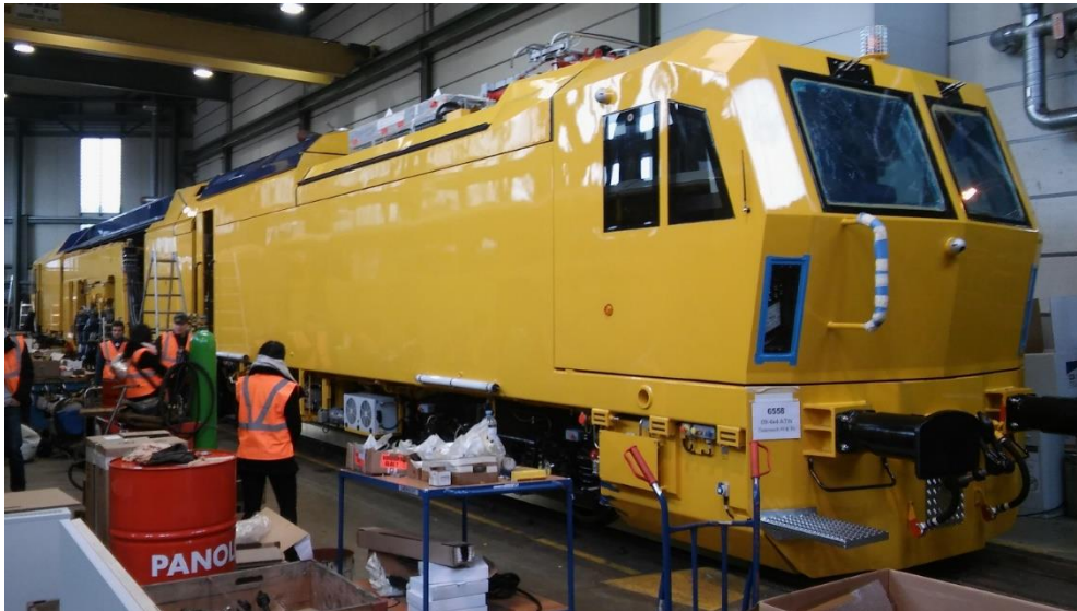
13. ábra: Dízel-elektromos hajtású (felül látható a pantográf) ágyazat aláverő és stabilizátor gép összeszerelés közben
